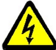
Tensione elettrica pericolosa
