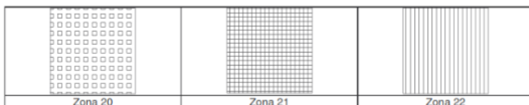
Figura 5 Simbologia da utilizzare nei disegni di classificazione dei luoghi con pericolo d'esplosione per la presenza di gas, vapori o nebbie infiammabili
