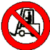
Vietato ai carrelli di movimentazione
